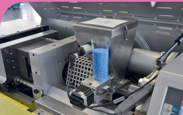
MCMicro est une unité de dosage ultracompacte, spécialement conçue pour les petites presses à injecter. Sa petite taille et son moteur pas-à-pas précis vous permettent de doser des additifs de façon intégrée sur les machines les plus petites du marché.
